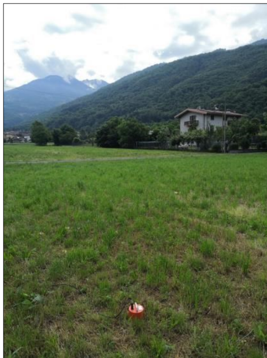
Acquisizione del microtremore sismico mediante tecnica HVSR
